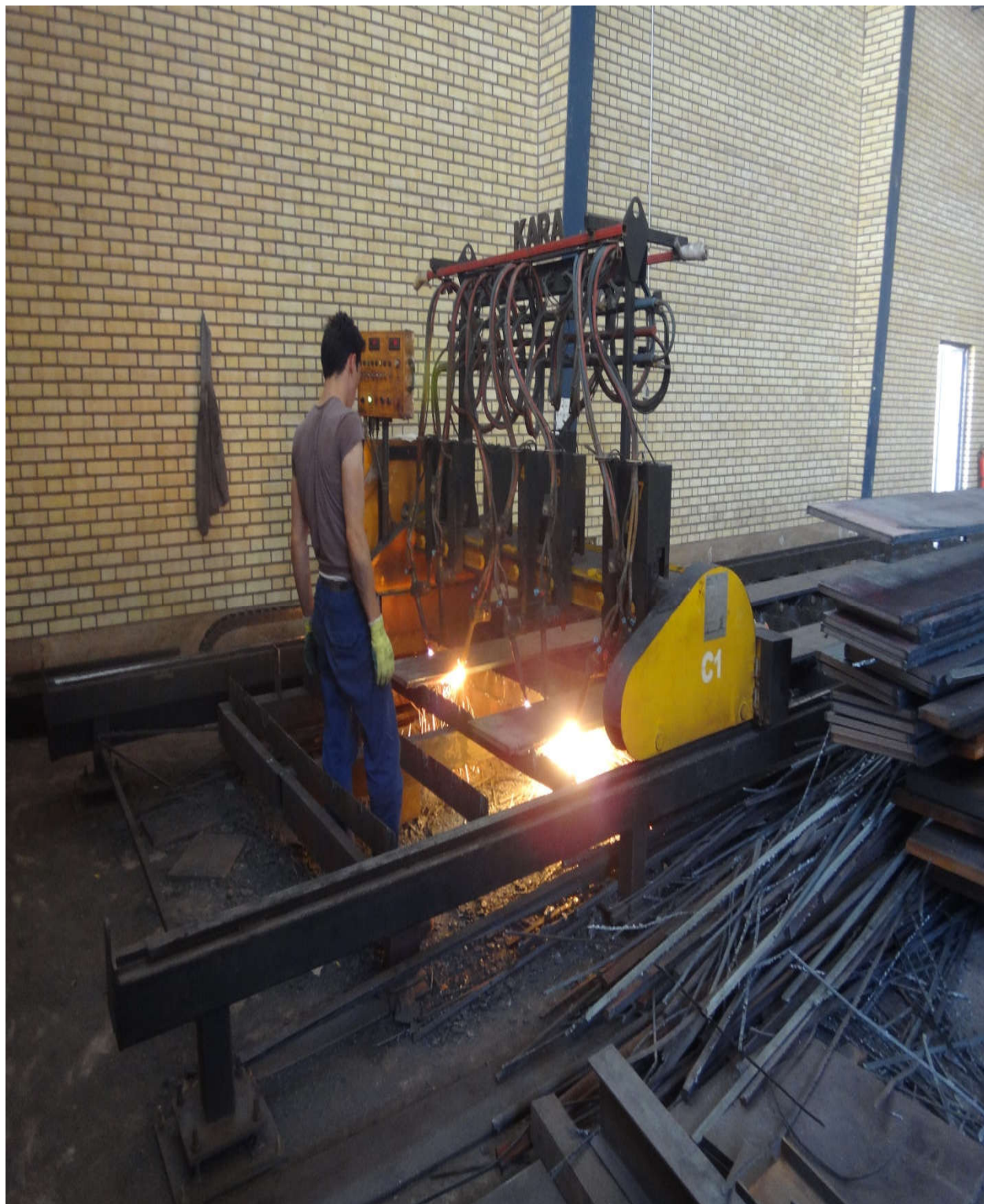
اجرای پخ ۴۵ درجه ورق ها به علت نوع جوش ( نفوذی ) تسمه ستون ها
